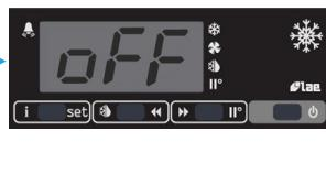
Cet affichage indique que l'appareil n'est pas en fonctionnement mais qu'il est relié au secteur. Ce mode peut être utilisé pour les opérations de nettoyage et de courtes périodes pendant lesquelles l'appareil n'est pas utilisé. Pour des périodes d'inactivité prolongées, il convient de couper l'alimentation secteur.
