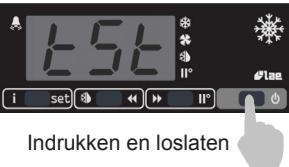
Opmerking: Indien u de toets niet indrukt, gaat de test door totdat deze is voltooid en de controller 'End' weergeeft. Na 1 minuut wordt de normale werking hervat.
