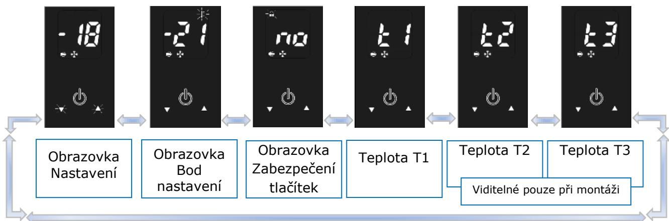
Pro ukončení tohoto režimu přejděte zpět na obrazovku Nastavení a stiskněte tlačítko nebo počkejte 30 sekund a zobrazení přede do normálního zobrazení a zobrazí provozní teplotu.
